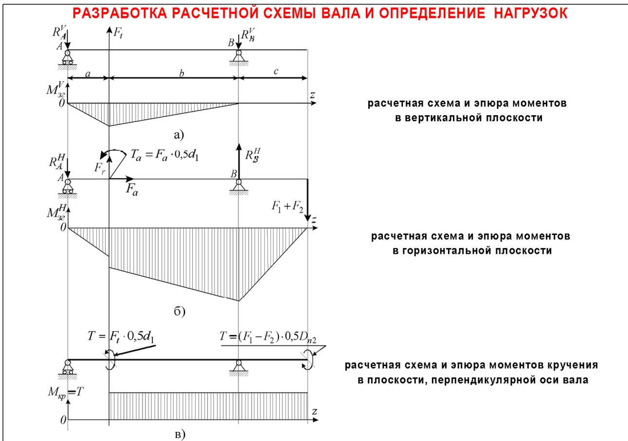
Рисунок 14.3 - Расчетная схема
