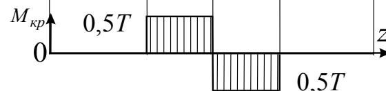
Рисунок 5.27 – Определение внутренних силовых факторов, действующих в поперечных сечениях промежуточного вала двухступенчатого шевронного редуктора с распределенной быстроходной ступенью
